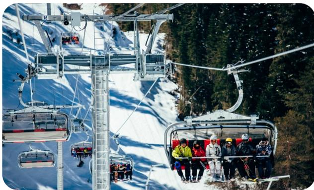
Наибольшее распространение получили кольцевые одноканатные дороги с постоянно закрепленным на несущем канате или отцепляемым на станциях подвижным составом. Эти дороги требуют меньших инвестиций и эксплуатационных затрат по сравнению с маятниковыми подвесными канатными дорогами, но при этом они обладают высокой надежностью и имеют большую пропускную способность (до 3 000 пассажиров в час на большие расстояния — до 10 км).
