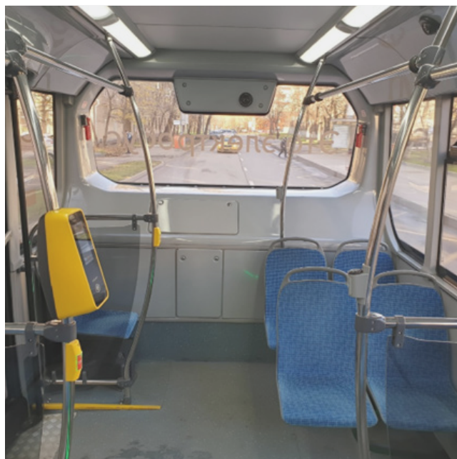
Рисунок 11. Салон автобуса с электродвигателем (электробус, троллейбус). На задней площадке вместо шахты имеется возможность размещения не менее 4 дополнительных сидячих мест.
