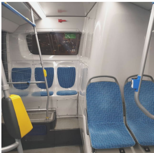
Рисунок 10. Салон дизельного автобуса. Шахта двигателя отнимает не менее 4 сидячих мест.
